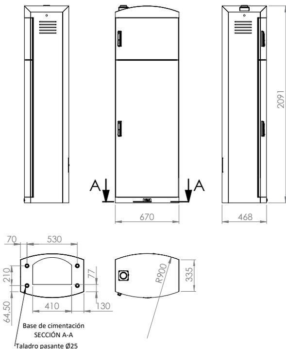
**Descripción:** Centro de mando para control de semáforos. Dispone de un bastidor interior dotado de sistemas de anclaje para componentes electrónicos estándar de gestión de semáforos. Su cuidado diseño hace posible instalarlo en diferentes entornos.
