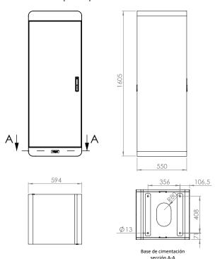
**Descripción:** Armario destinado a la gestión del alumbrado público. Diferente compartimento para medida y aparamenta. Su esbelto diseño permite instalarlo en prácticamente cualquier entorno.
