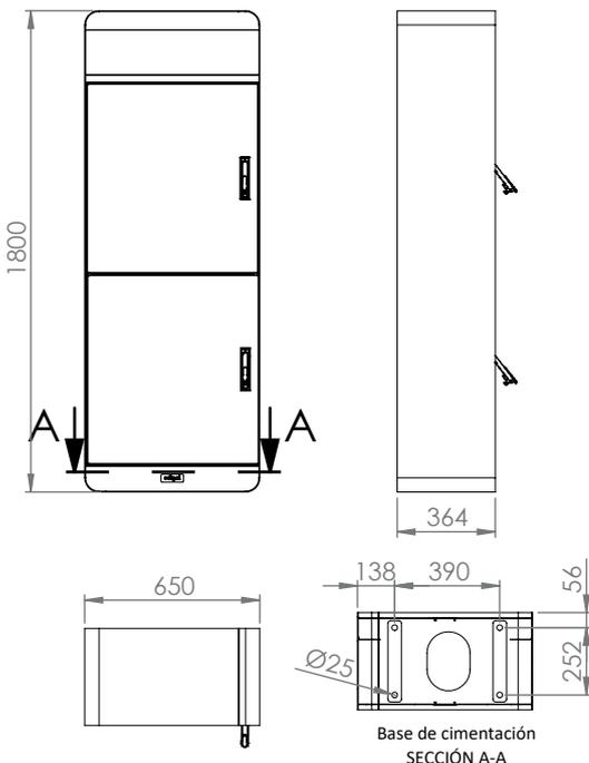
**Descripción:** Armario destinado a la gestión del alumbrado público. Diferente compartimento para medida y aparamenta. Su esbelto diseño permite instalarlo en prácticamente cualquier entorno.
